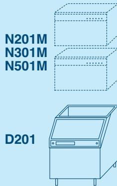
Il KS201-301 ed il KS501 sono accessori che è necessario montare sulla macchina inferiore (N201M-N301M e N501M rispettivamente) in caso di sovrapposizione.
