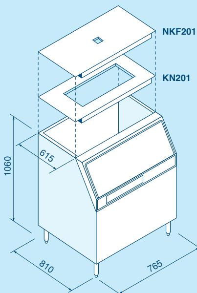
Capacità di deposito sino a 150 kg in dimensioni LxPxH **765x810x1060** mm.
