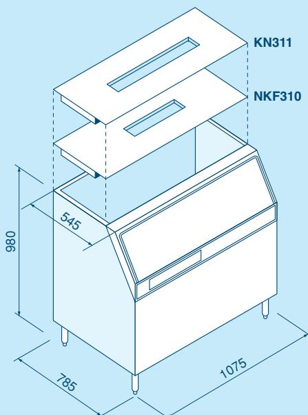
Capacità di deposito sino a 210 kg in dimensioni LxPxH **1075x785x980** mm.
